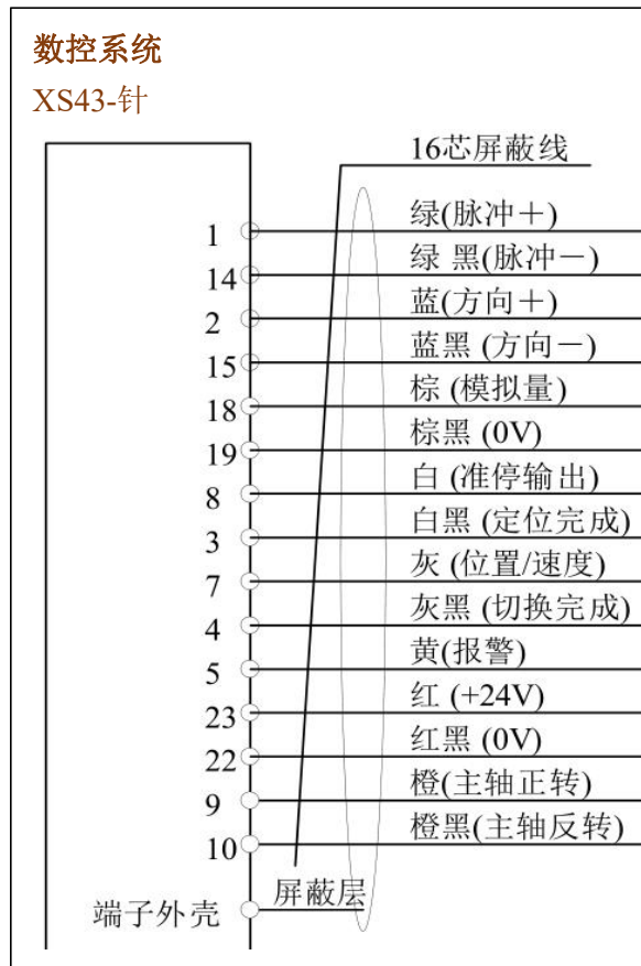
脉冲型伺服主轴接线参考图：
