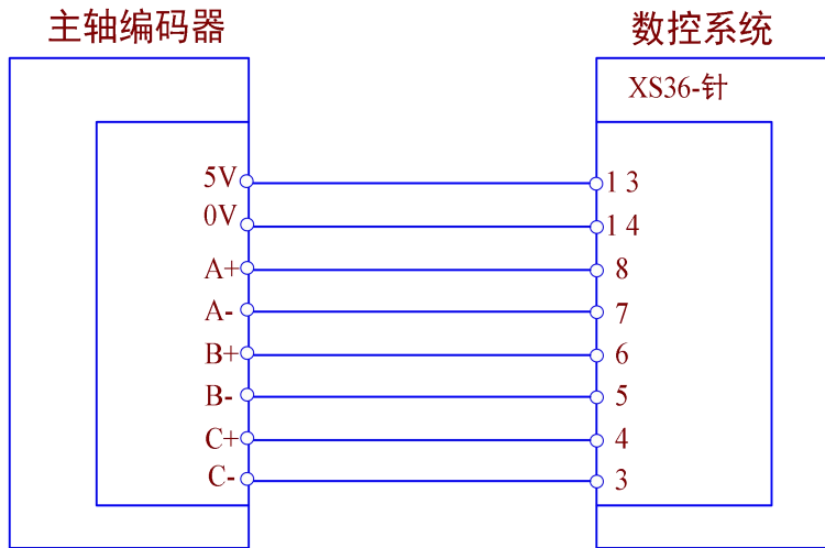
脉冲型伺服主轴接线参考图：
